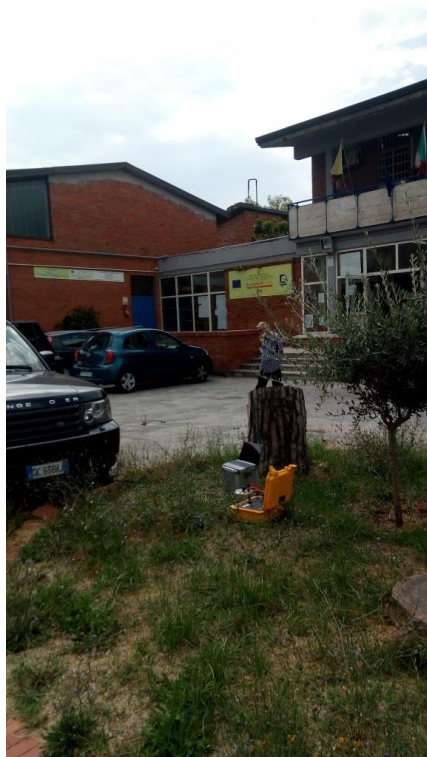
Foto 1 - 2- Prova di sismica passiva HVSr1
