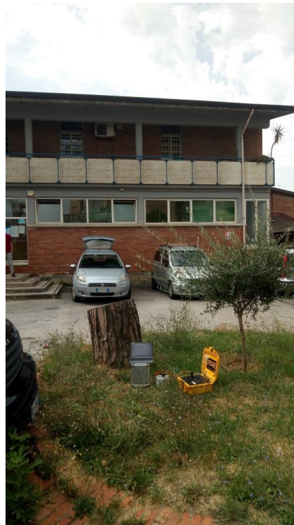
Foto 1 - 2- Prova di sismica passiva HVSr1
