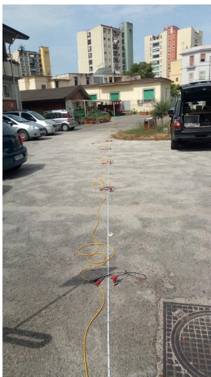
Foto 3 - Stendimento sismico MASW 1 – TOMO1
